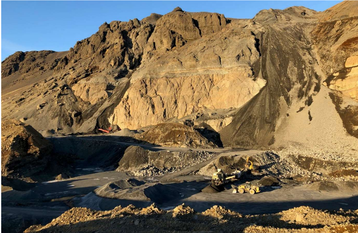
MYND 3.5 Hér sjást brjótarnir tveir sem eru að staðaldri í námunni ásamt beltagröfu og hjólaskóflu.
