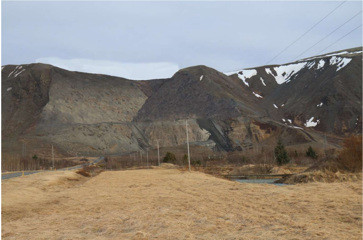
MYND 4.8 Þórustaðanáma séð frá heimreið að Þórustöðum þegar efnistaka er vel á veg komin. Búið er að vinna efni niður að þétta berggrunninum í botni fjallsins og myndast stallur þar ofan á. Enn er verið að ýta efni niður fram af þeim stalli.
